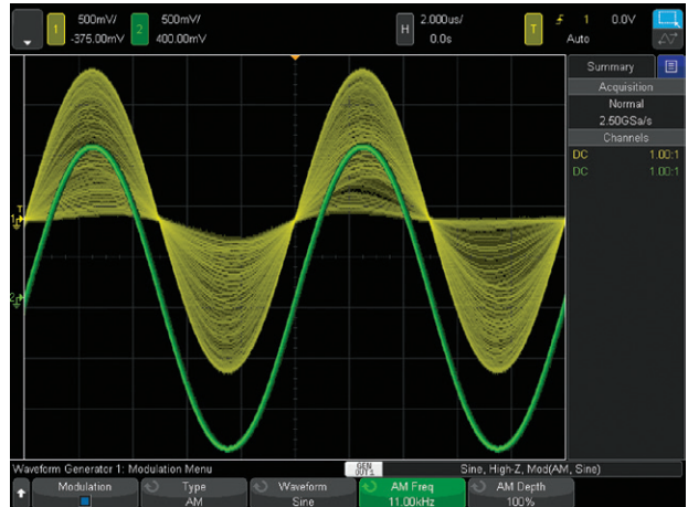
그림 21. 추가 AM WaveGen 변조 유무에 따른 사인파 출력
