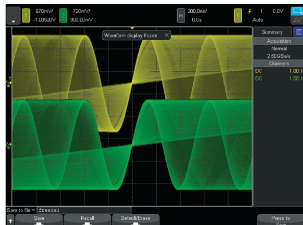
그림 43. “프리즈 스크린(freeze screen)” 기능은 파형 수집을 중단시킨 동안 밝기 강도 정보를 유지합니다.
