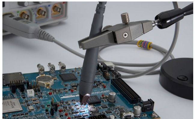
그림 34. N2744A T2A 프로브 인터페이스 어댑터를 이용하여 키사이트 오실로스코프와 함께 Tektronix TekProbe 프로브 활용
