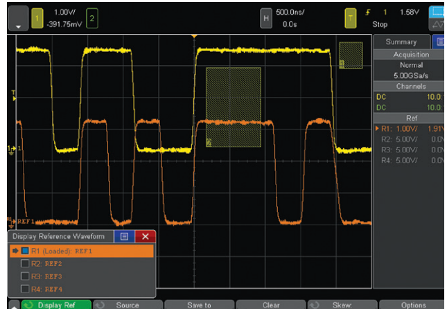
그림 33. 최대 4개 참조 파형 저장 및 호출
