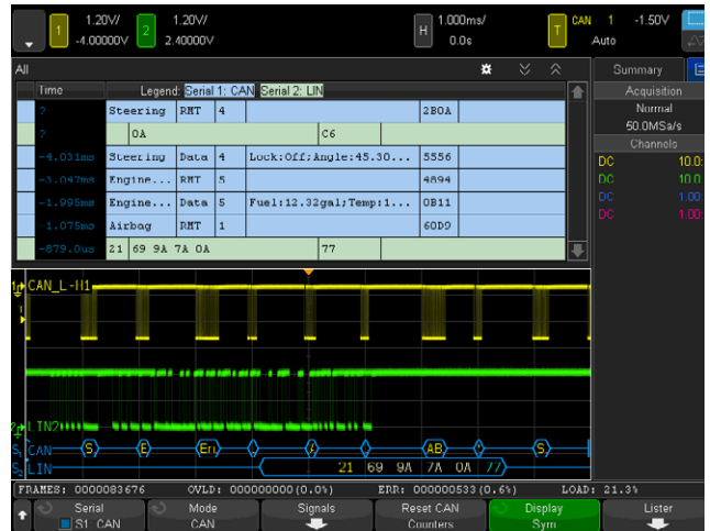
그림 19. 듀얼 시리얼 버스 CAN 및 LIN 디코딩/interleave 방식의 “리스트어” 표시
