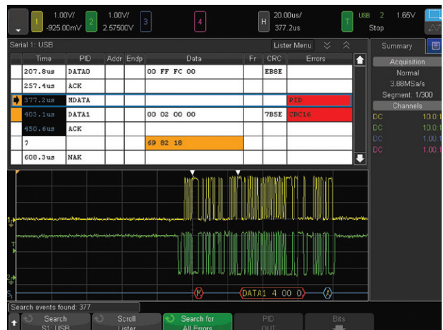
그림 20. USB 2.0 트리거, 디코딩 및 “리스트어” 표시
